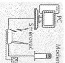
**Krok 3:** Zapojte jeden konec přibaleného ethernetového kabelu do portu s označením „1“ na zadní straně směrovače a druhý konec do ethernetového portu počítače.
